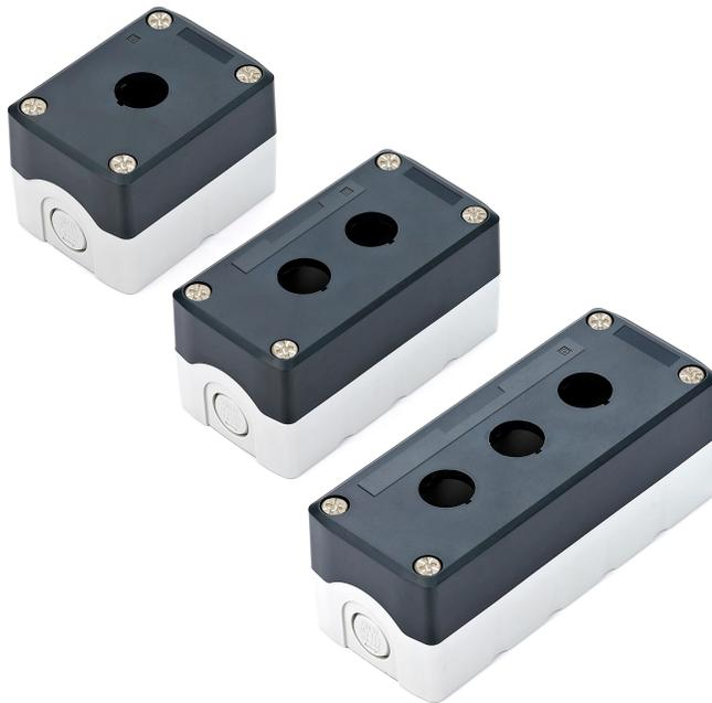
Cajas botoneras modulares de una, dos y tres perforaciones de Ø22 mm, diseñadas para el montaje de pulsadores, selectores y señalizadores en sistemas de control y automatización industrial. Compatibilidad universal con dispositivos de control Ø22 mm. Grado de protección IP65, adecuado para ambientes con polvo y humedad. Entrada para prensaestopas, permitiendo un cableado seguro y ordenado.
