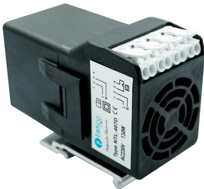
Estos calefactores se utilizan en gabinetes donde debe evitarse el daño por condensación o donde la temperatura no debe caer por debajo de un valor mínimo. El diseño del cuerpo calefactor de perfil de aluminio genera un efecto chimenea y distribuye el calor de manera uniforme. Los calefactores están diseñados para funcionamiento continuo. Los conectores de presión tipo clamp ahorran tiempo y simplifican la instalación.
